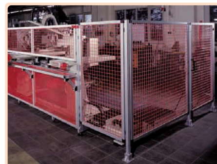
Ces systèmes de cartérisation et de cloisonnement n'exigent pas de fixation au sol. (Phoenix Mecano Komponenten AG, page 73)
