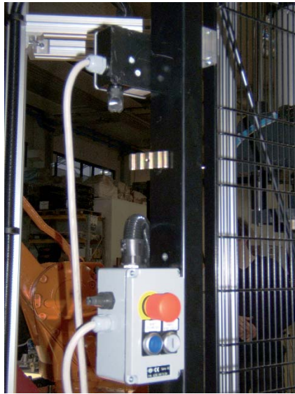
Fig. 4. L'adaptateur Tina 2A avec filetage M20, facile à monter, rend n'importe quel interrupteur ou bouton-poussoir à contacts mécaniques compatible avec le module électronique de sécurité Vital. (Photo: Jokab Safety)
