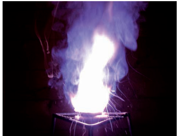
Un mélange de chlorate de potassium et de soufre brûlant vigoureusement. Copyright: Cyberchemist.
