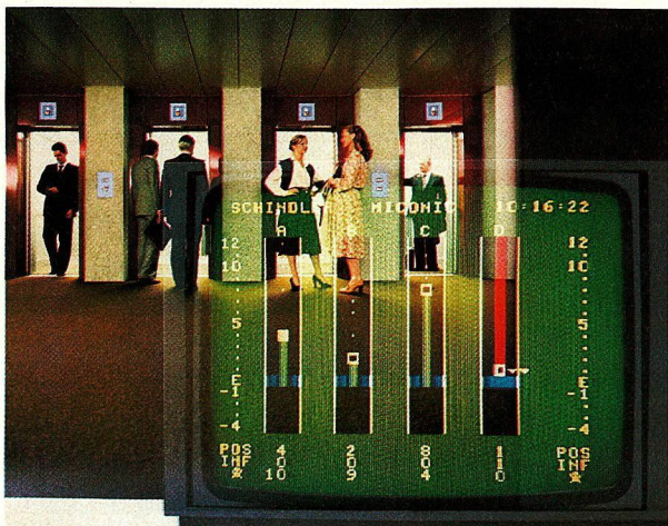
Fig. 3. Système de communication Miconic V de Schindler, pour la visualisation de l'installation, le diagnostic et les réglages par logiciel.
