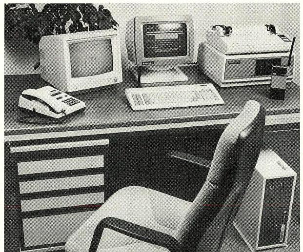
Fig. 1. La station de contrôle AGUS avec l'ordinateur personnel l'écran graphique couleur, l'écran texte, l'imprimante ; sous la table, un Telebit 08. The AGUS control station with the personal computer, the graphic color and the text screens, the printer ; under the table a Telebit 08.
