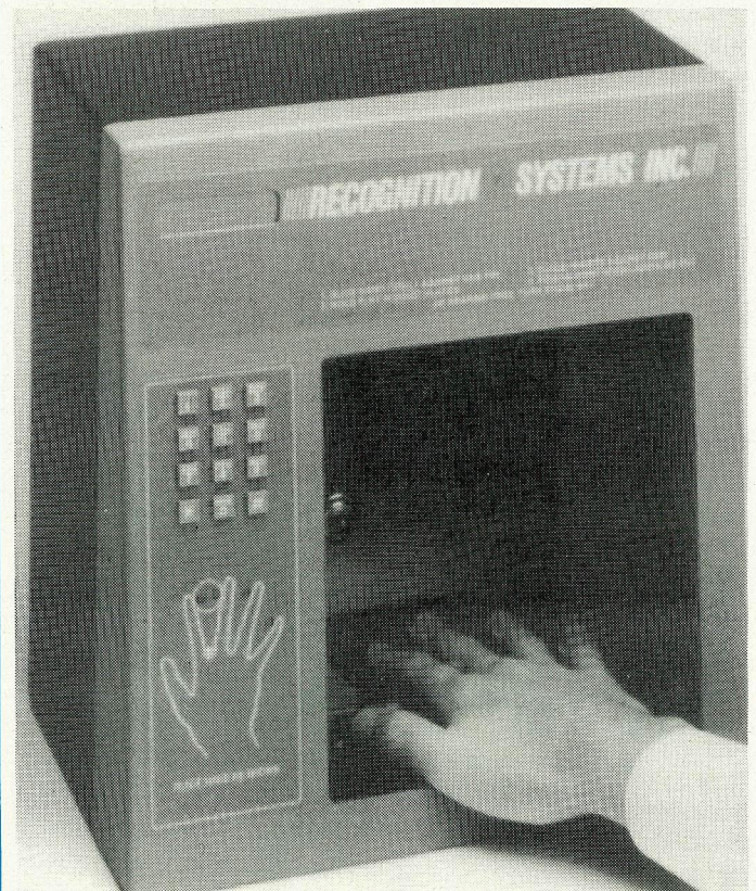
Le système ID 3D est un dispositif biométrique qui travaille par reconnaissance de géométrie de main
